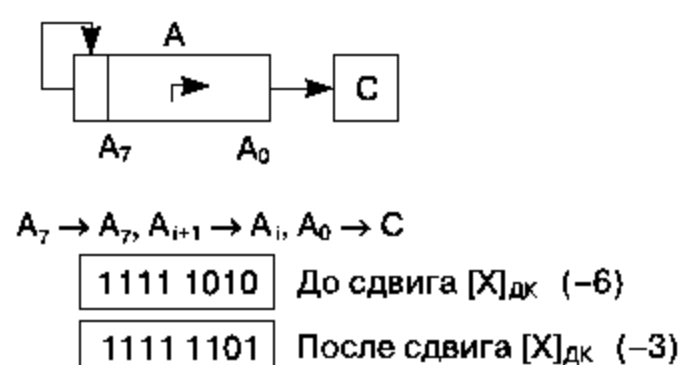
Рис. 4.70. Арифметический сдвиг вправо на один разряд
