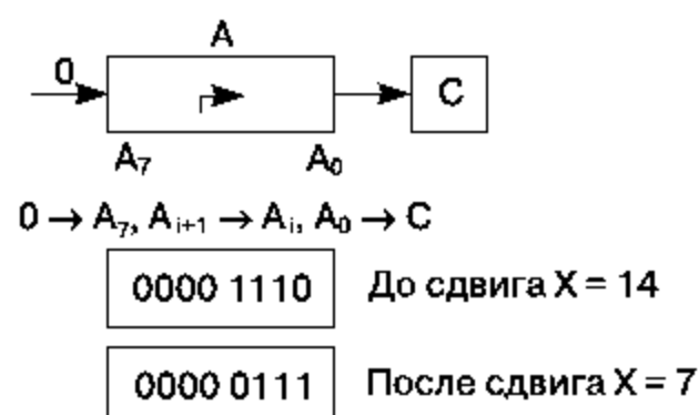
Рис. 4.69. Логический сдвиг вправо на один разряд
