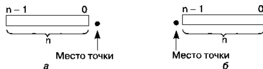
Рис. 4.14. Разрядные сетки чисел с фиксированной точкой а — после младшего разряда; б — перед старшим разрядом
