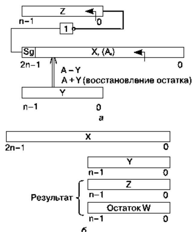
Рис. 4.66. Деление со сдвигом делимого:
